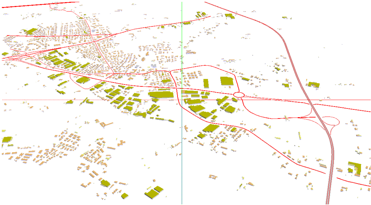
Figura 4 – modello di calcolo elaborato su software dedicato (SoundPLAN)
