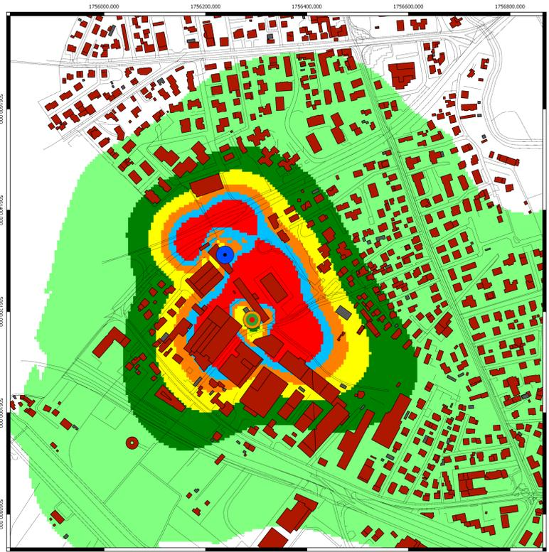
Campo elettromagnetico (V/m) calcolato alla quota di 18,4 m sul livello del terreno
