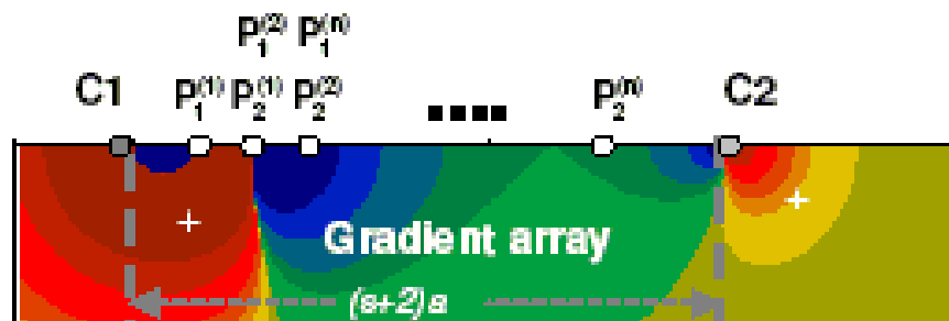
Figura 14 - Schematizzazione del dispositivo quadripolare tipo "Gradient array", utilizzato per l'acquisizione dei dati di resistività elettrica
